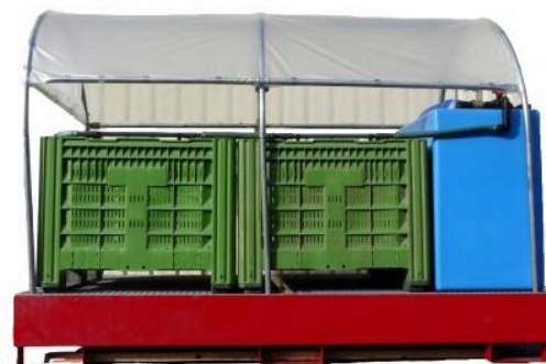
Fig. 1: Installation Biobac® de CCD SA avec deux conteneurs de 550 litres chacun (dimensions: 1,2m X 1m) comprenant un système d'irrigation automatique ainsi qu'un toit. Image: CCD SA
